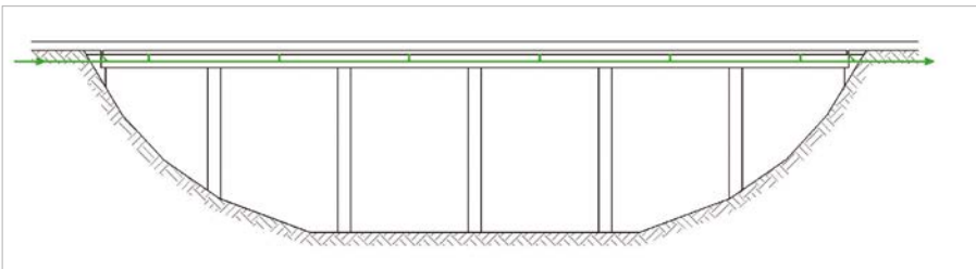
Fassen der Entwässerung mit Längsleitung und Ableitung oder Weiterführung am Widerlager Einbindung der Brückenentwässerungsleitung in bestehende Straßenentwässerungsleitung
