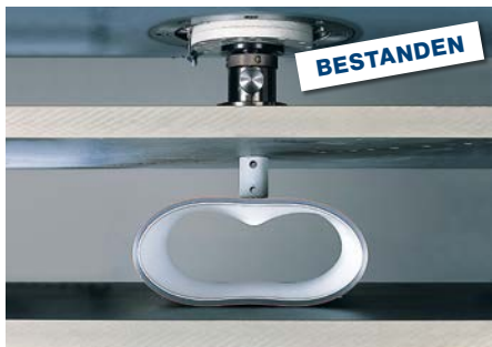
Durchstoßprüfung mit Spitzdorn
