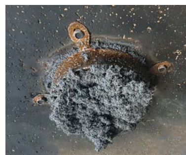
Feuer- und heißgasdichter Verschluss nach dem Auslösen der Brandschutzmanschette
