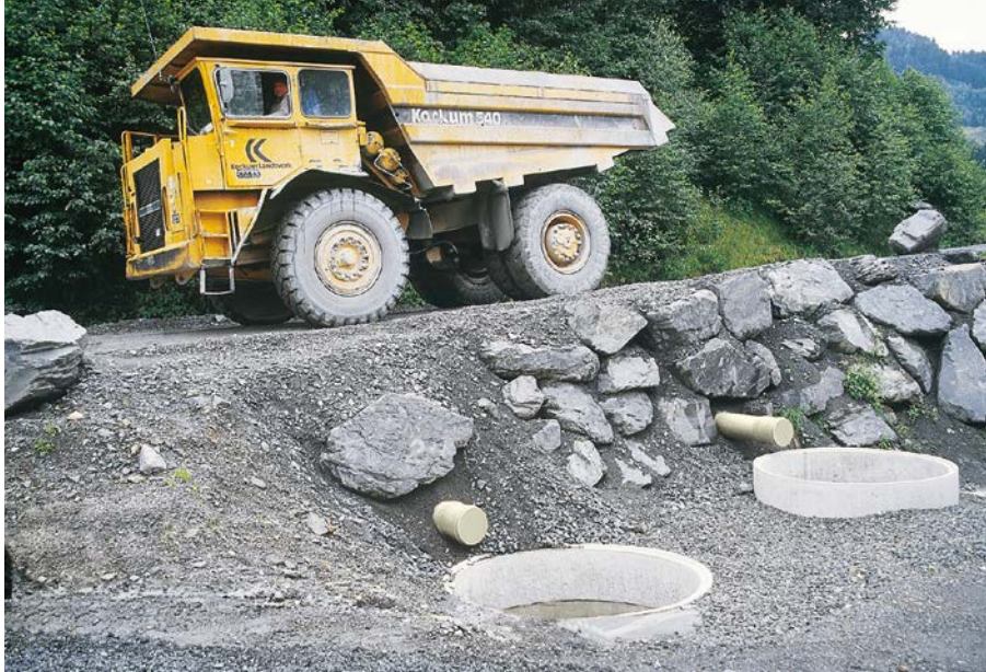
Fahrbahn: Schotterstraße ohne lastverteilende Wirkung durch eine Asphalt- oder Betondecke, max. Fahrzeuggewicht samt Ladung ca. 57 t.
