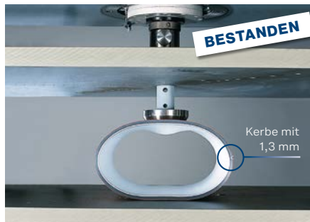
Punktlastprüfung mit seitlicher Einkerbung
